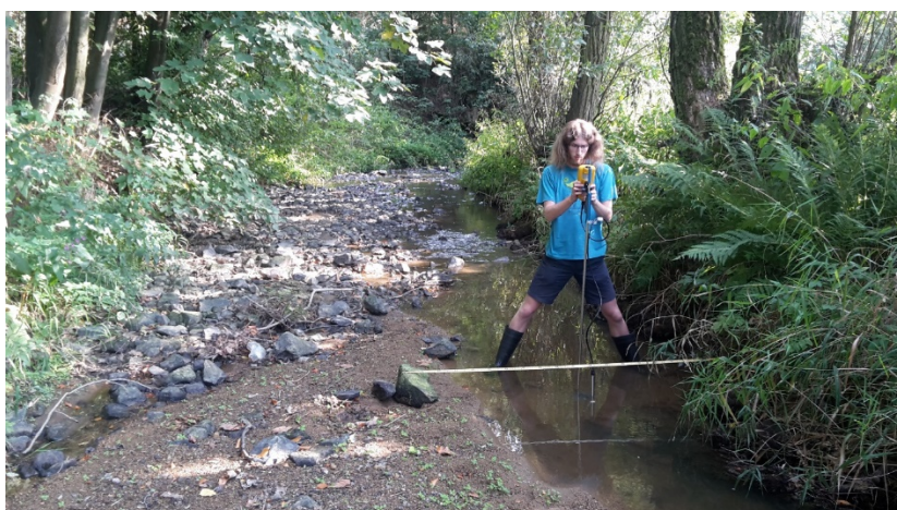
Foto 6.1 Měření průtoku na Borovském potoce ve Stříbrných Horách dne 28. 8. 2018 přístrojem FlowTracker (foto: Tomáš Fryč).
