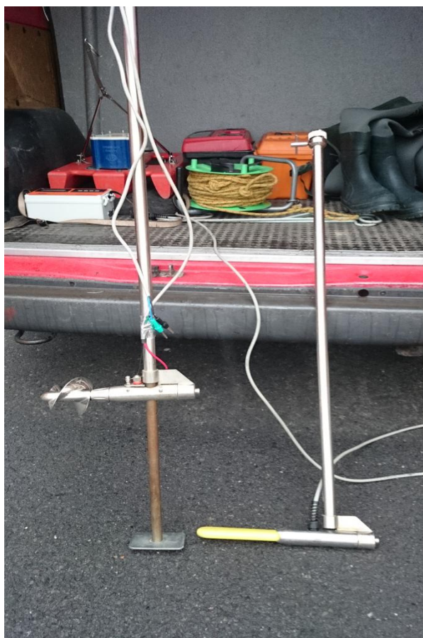
Obr. 1 Hydrometr. vrtule OTT C31 (vlevo) a OTT Nautilus 2000 (vpravo)
